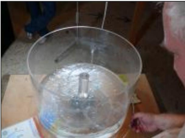
Das Exponat besteht aus einem Brunnen, der um seine Brunnenmitte drehbar ist. Dabei strömt das Wasser aus zwei Düsen in Richtung der Drehachse und aus zwei Düsen in entgegengesetzter Richtung.
