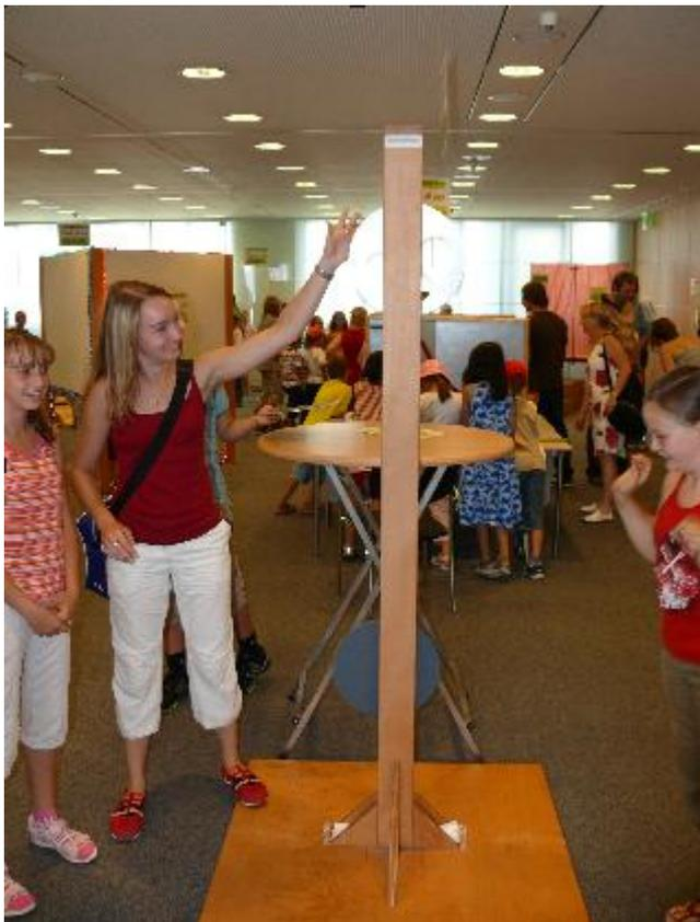
Das Exponat besteht aus einer ca. 2 m hohen Säule, die in der Mitte einen 1 cm breiten Schlitz hat. In der Säule sind Magnete eingebaut, die ein starkes magnetisches Feld erzeugen.
