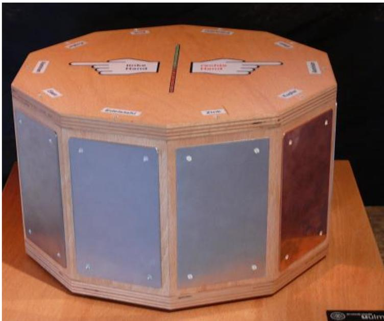
Das Exponat besteht aus einem etwa 1 m<sup>2</sup> großen Tisch, auf dem ein drehbares Polygon (Ø 50 cm, Höhe 20 cm) und die LED-Anzeige eines Spannungsmessgerätes angebracht ist. Auf den zehn Seiten des Polygons befinden sich Platten, die aus verschiedenen Metallen bestehen. Dabei ist immer auf den beiden gegenüberliegenden Seiten des Polygons dasselbe Metall angebracht.
