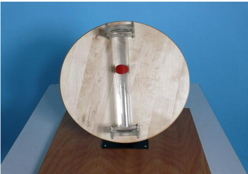
Das Exponat besteht aus einem ca.  $1,5 \text{ m}^2$  großen Tisch. Über einen Gelenk wurde eine drehbare Scheibe mit dem Tisch verschraubt. An der Scheibe ist eine mit Wasser gefüllte Röhre befestigt, in der ein mit Luft gefüllter Ball schwimmt. Dank des Gelenkes kann man die Scheibe stufenlos bis  $90^\circ$  neigen. Sie kann sich also parallel und senkrecht zum Tisch drehen.
