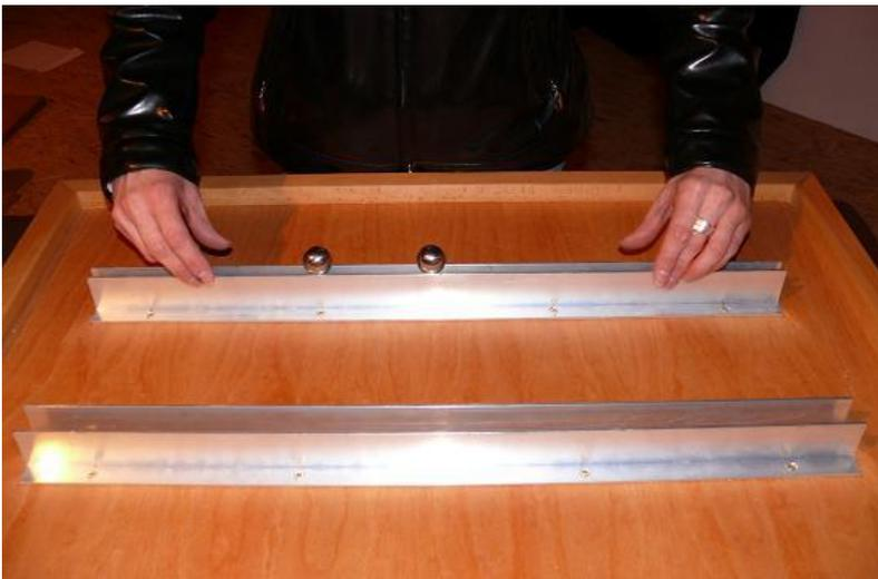
Das Exponat besteht aus einem Tisch, auf dem zwei Schienen mit unterschiedlichem Spurabstand stehen. Zwei Metallkugeln liegen links und rechts auf den Schienen. (Diese schubst man von außen nach innen langsam aber gleich schnell nach innen.)
