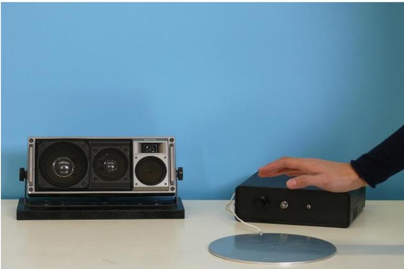
Das Exponat besteht im Grunde aus einem elektronischen Kasten, der mit einer runden Antennenscheibe verkabelt ist.
