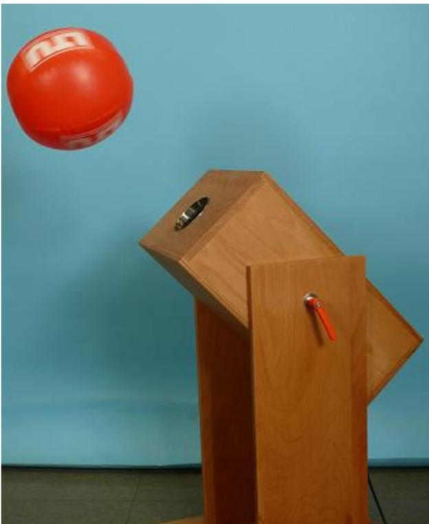
Das Exponat besteht aus einem Gebläse, das durch einen gut erkennbaren roten Knopf in Betrieb genommen werden kann. Desweiteren liegt am Exponat ein Wasserball bereit, mit dem am entstehenden Luftstrom experimentiert werden kann.
