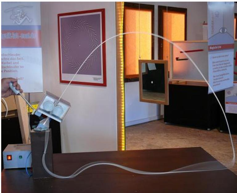
Das Exponat besteht aus einem Motor, der auf einem Tisch befestigt ist und über einen Schalter in Betrieb genommen werden kann. Dieser Motor beschleunigt ein weiches Seil, dessen Enden miteinander verbunden sind. Durch eine Handkurbel kann die Seilschleuder in verschiedene Positionen gekippt werden.
