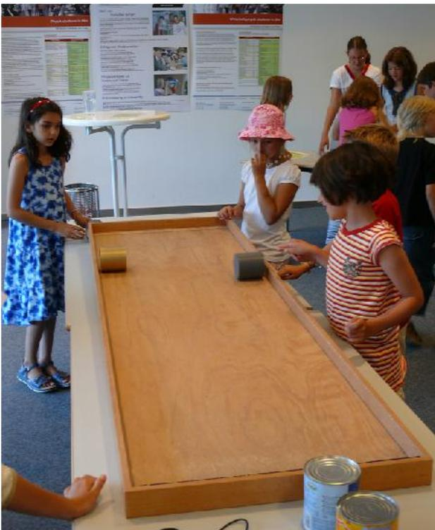
Das Exponat besteht aus einer leicht schiefen langen Ebene. Dem Exponat sind außerdem zwei gleich schwere Zylinder beigefügt, die denselben Durchmesser und die dieselbe Höhe haben. Ein Zylinder ist allerdings innen hohl, der andere massiv.
